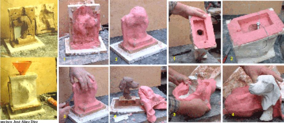
MOLDES DE RECUBRIMIENTO CON SILICONA APLICADA CON BROCHA
