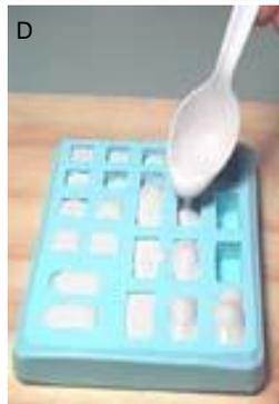
D.- Con la misma cucharilla echaremos la mezcla en el molde y con golpes en la misma mesa con el puño haremos que el estuco vibre se esparza por los huecos del molde de un bloque como en la figura.
