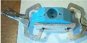
Antes de proceder al colado aplicaremos desmoldante a las superficies del molde. Luego verteremos el material colado y dejaremos secar. El material colado aparecerá por los orificios de ventilación y necesitará ser retirado, así como la piqueta de colada. Alrededor de la réplica nos pueden aparecer rebabas, que también retiraremos con cuidado con un cutter.
