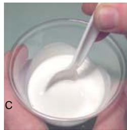
C.- Para eliminar los grumos y conseguir una mezcla homogénea, revolveremos la mezcla con una cucharilla desechable o algo similar. La consistencia que deberemos lograr es la de una masa de gofre (o frisuelo). Si la masa es muy fina, tendrá mucho agua y verterá bien sobre el molde pero no se espesará por los huecos del molde de un bloque como en la figura.
